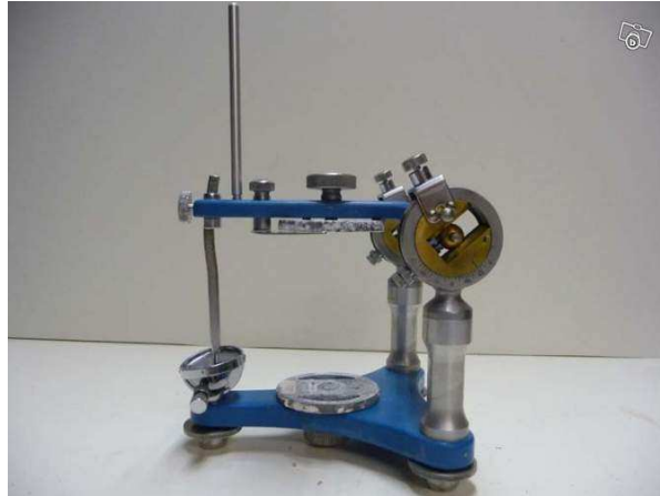
Figure 4 : Articulateur de marque Dentatus © avec réglage des latéralités et des pentes condyliennes
